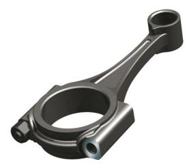
连杆是将其两端分别与主动和从动构件铰接以传递运动和力的杆件。连杆是汽车发动机 中的重要零件之一,它连接着活塞和曲轴,其作用是将活塞的直线往复运动变为曲轴的旋转 运动,并将作用在活塞上的力传给曲轴以输出功率。连杆既受交变的拉压应力、又受弯曲应 力,材质多为调质钢。
