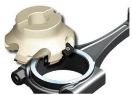
FMA01/02 系列<u>刀具</u>,刀盘分密齿和疏齿不等齿,大前角设计,切削轻快,配合多种槽型及修光刃刀片,适合钢、合金钢、不锈钢、铸铁、铝合金、高温合金等多种材质的精加工及半精加工。
